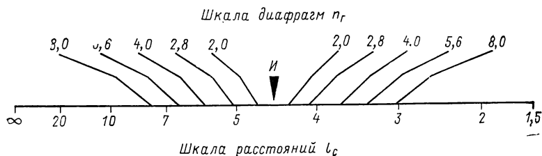
Рис. 9.4. Шкала расстояний со шкалой для определения глубины резко изображаемого пространства
